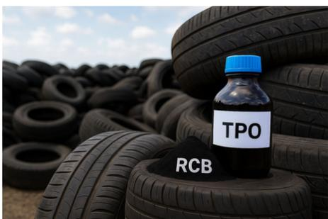
La pyrolyse est un procédé qui consiste à chauffer à haute température (600°C) et sans oxygène le caoutchouc des pneus usagés. On en extrait du noir de carbone recyclé (RCB) et du gaz / huile (TPO). Le RCB pourra alimenter entre autre l'industrie du caoutchouc et le TPO est un substitut au pétrole brut.
